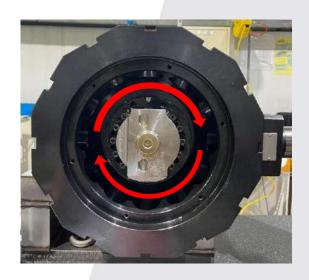
步驟 5. 調整齒輪頭精度在 0.02mm 內, 並鎖緊齒輪頭固定螺絲。
