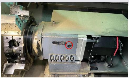
步驟 3. 使用扭力板手, 從左側孔放鬆齒輪頭迫緊塊固定螺絲。該螺絲依型號分M10 扭力為 77Nm; M6 扭力為 16Nm,裝回時也務必上妥扭力。
