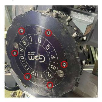
步驟 2. 拆卸刀塔本體左側之塞頭螺絲 (請注意板金是否蓋住,若蓋住請拆卸板金)
