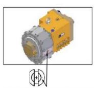
齒輪頭耦合齒必須與刀盤孔同心並和導軌成平行
