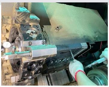
步驟 4. 此時齒輪頭因後方固定螺絲已鬆脫,即可 360 度轉動。
