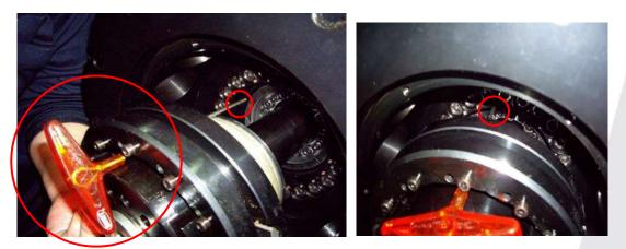
(用 T 型板手去做齒輪頭固定螺絲的定位動作。
