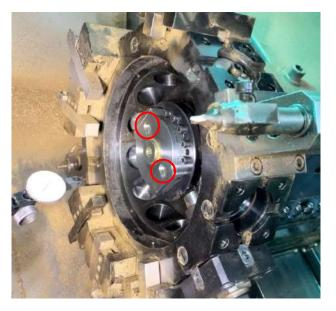
步驟 9. 動力馬達回裝後,必須重新設定動力刀原點位置。
