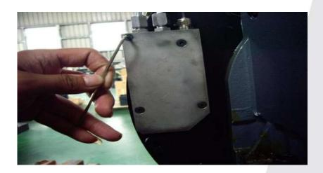
步驟 2.將本體上方及油壓缸油管拆除,請務必停止油壓系統以免液壓油外洩。
