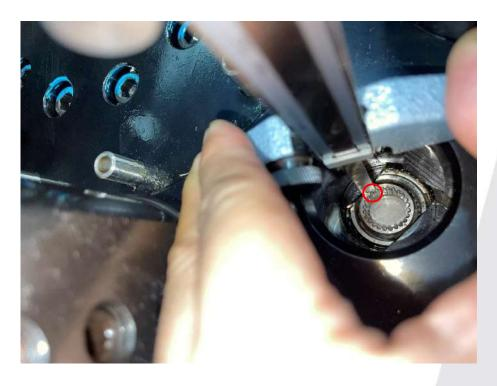
1. 使用 4mm 板手,轉動耦合齒後方止付螺絲調整耦合齒位置.
