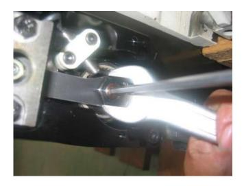
4-2. 或用 17mm 套筒鎖緊,使用套筒有一個缺點,因為沒有 4mm 板手可以固定止付螺絲,鎖
