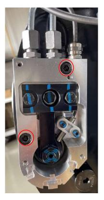
步驟 4 將油壓缸固定座拿出。
