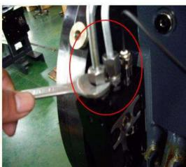
步驟 3.將油壓缸固定座螺絲拆除。
