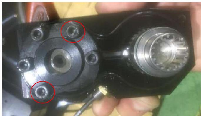
4.注意 O-ring 不可遺失，更換此組零件，反向裝回新品
