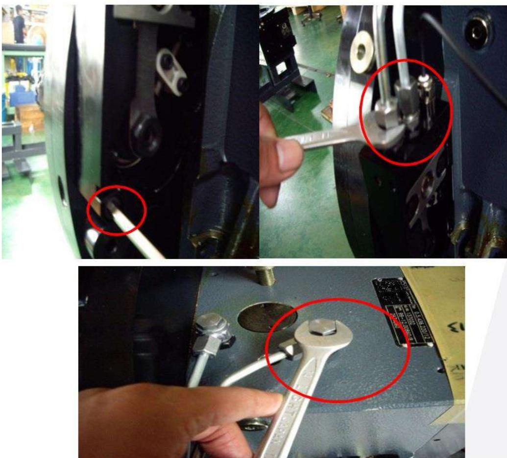
步驟 11. 油管裝回後，請將油壓系統打開，並強制鬆刀及 S11 信號為 1 狀態下，將油壓缸螺母以去漬油洗淨，使用 242 螺絲固定膠在螺母上鎖緊。
