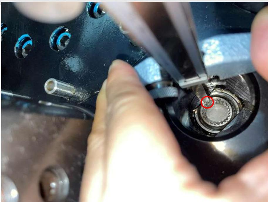
步驟 14. 確認 C 軸定位角度需將齒輪記號設定在三點鐘方向。
