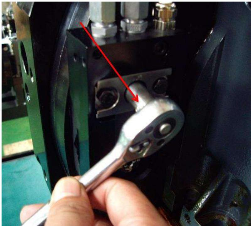
步驟 12. 請測試換刀，確認油管部分是否沒鎖緊導致漏油，也順便將油壓管線中空氣排除，測試若無問題即完成。
