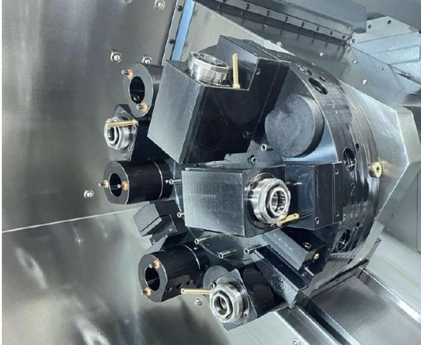
1. 刀塔回到 1 號刀位置並在鎖緊狀態
