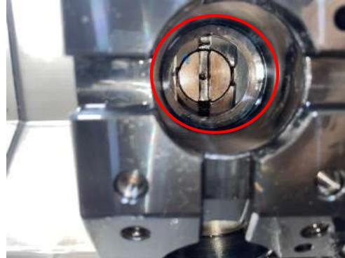
2. 確認刀塔端及動力刀座耦合齒是否受損?
