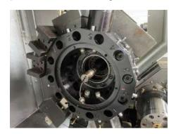
齒輪頭拆除後,請在一號刀位將刀盤固定螺絲取下。使用膠槌敲擊刀盤背面取刀盤。(拆卸刀盤時,請使用吊具固定刀盤,以免人員受傷),移除刀盤時注意油壓芯軸不要撞擊到。
