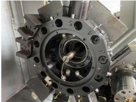
1. 齒輪頭拆除後，請在一號刀位將刀盤固定螺絲取下。使用膠槌敲擊刀盤背面取刀盤。(拆卸刀盤時，請使用吊具固定刀盤，以免人員受傷)，移除刀盤時注意油壓芯軸不要撞擊到。
