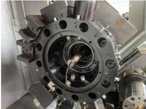
齒輪頭拆除後，請在一號刀位將刀盤固定螺絲取下，使用膠槌敲擊刀盤背面取刀盤。(拆卸刀盤請使用吊具固定刀盤，以免人員受傷)，移除刀盤時注意油壓芯軸不要撞擊到。
