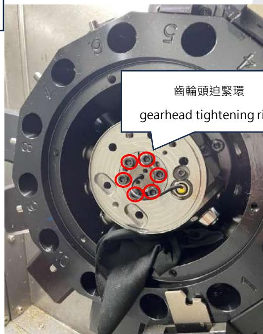
放鬆迫緊環螺絲後，旁邊的螺絲孔再鎖上螺絲以逼鬆迫緊環
