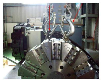
步驟 2. 拆除刀盤前方 8 個螺絲,用橡膠槌敲打刀盤背面將刀盤卸下。 (注意:卸除刀盤請在原點即 1 號刀卸除)
