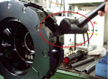
434/BMT 款的 T 型塊不是鎖定位珠固定,是用 T 型塊(圖 1)加隔環(圖 2) 跟波形墊片(圖 3),故如需拆下檢查,請使用一根六角板手頂住 T 型塊螺絲 孔後往下壓即可取出檢查。
