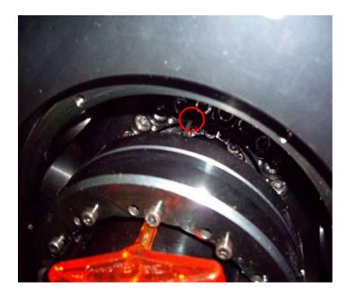
c-8 齒輪頭裝回後,先確認耦合齒與工作刀位大約同心
