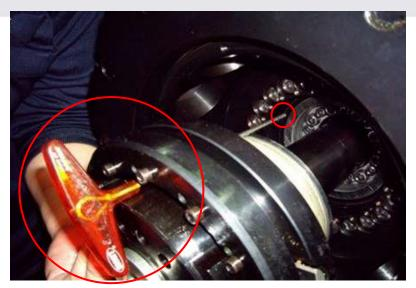
用T型板手去做齒輪頭固定螺絲的定位動作
