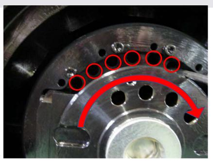
c-4.將固定螺絲根螺絲拆卸完後即可將齒輪頭敲出,用一根塑膠棒頂住心軸後 方用槌子敲出,因齒輪頭有點重量,故前方需有人接住,以免造成撞傷或難以 敲擊.
