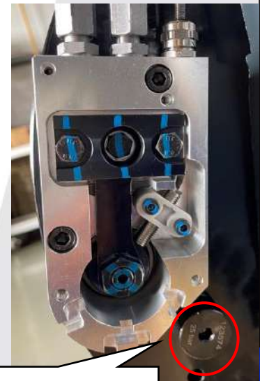
出水閥 Coolant valve
