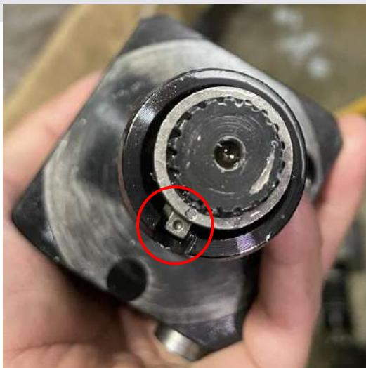
10. 把加工刀位的刀座移除後，檢查刀塔夾緊放鬆，檢查耦合齒油壓缸前後作動是否正常。
