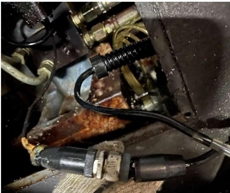
5. 檢查刀塔 S8 訊號夾緊為 1;放鬆為 0 · S10 耦合齒訊號耦合時為 1;脫離為 0
