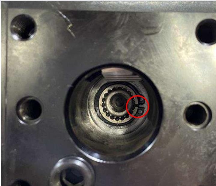
12. 刀塔撞車後造成刀盤或耦合齒中心位置偏移。
