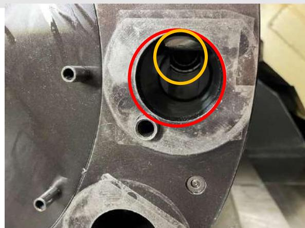
14. 動力機構進水生鏽卡死，內部軸承或齒輪損壞，關掉動力馬達電源，手動
