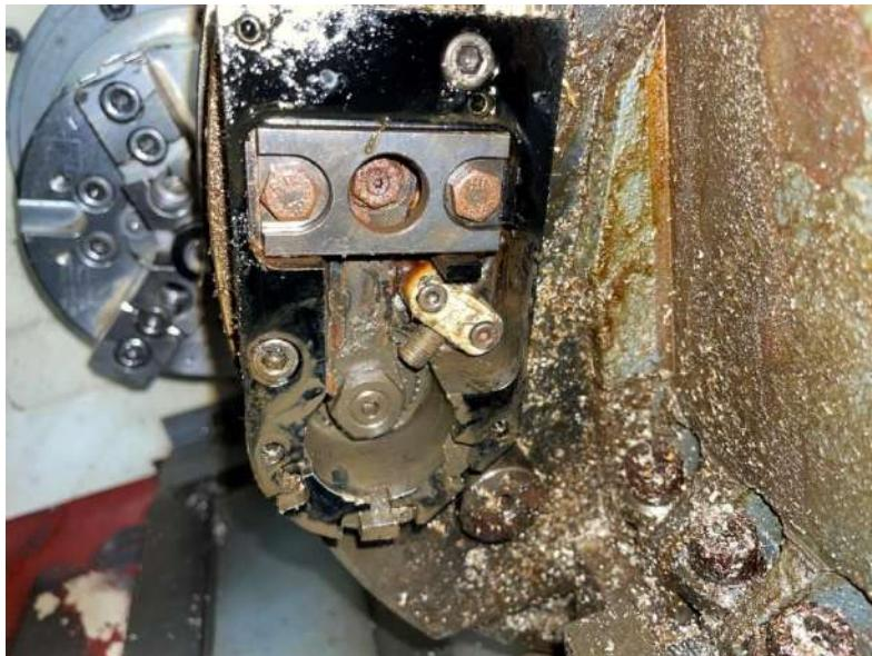
15.量測刀塔夾緊時耦合齒的距離是否在標準內
