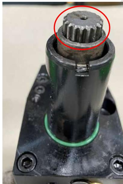
9. 動力刀座安裝前需先手動定位，定位時確認刀座無法轉動
