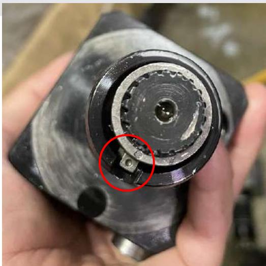
11. 刀塔夾緊放鬆，檢查耦合齒油壓缸前後作動是否正常
