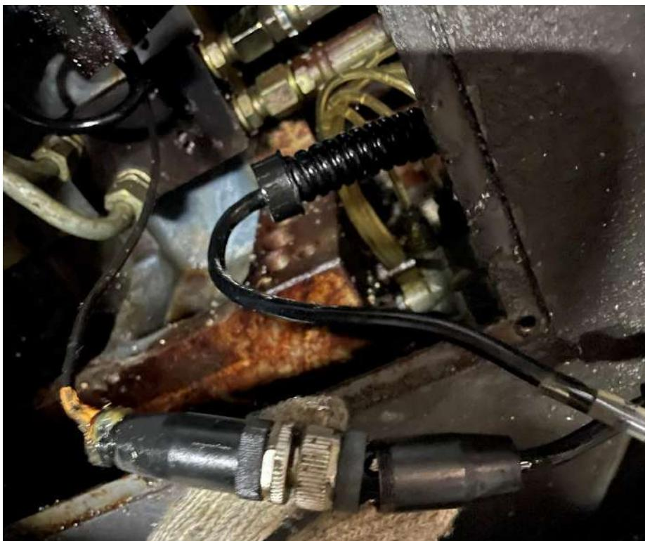
5. 檢查刀塔 S8 訊號夾緊為 1 放鬆為 0 · S11 耦合齒訊號耦合時為 0 脫離為 1
