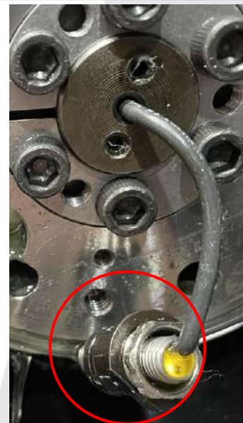
5. 放鬆刀塔後方線路迫緊及近接開關接頭後, 即可從齒輪頭芯軸前端拉出。
