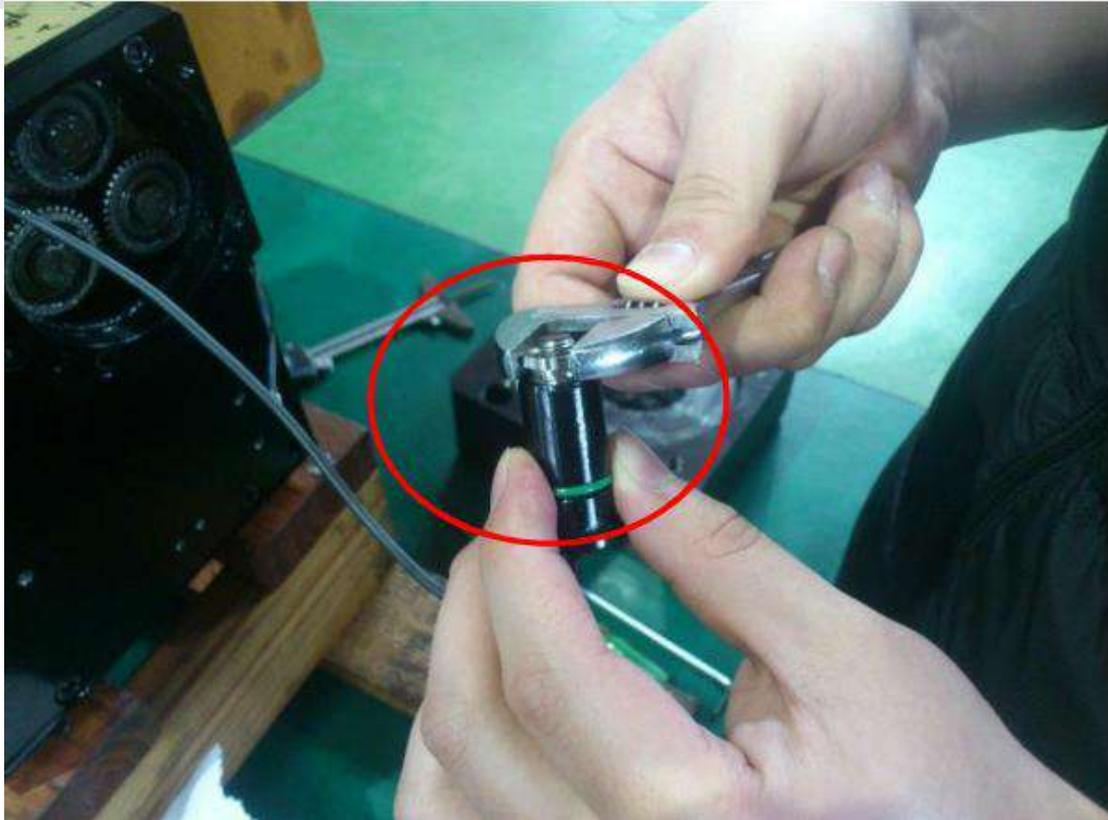
步驟 5. 換上新 S1 後，使用游標卡尺，將 S1 調整至同步驟 3 所記錄之距離後，再將固定螺帽鎖緊，再量測一次距離是否正常。
