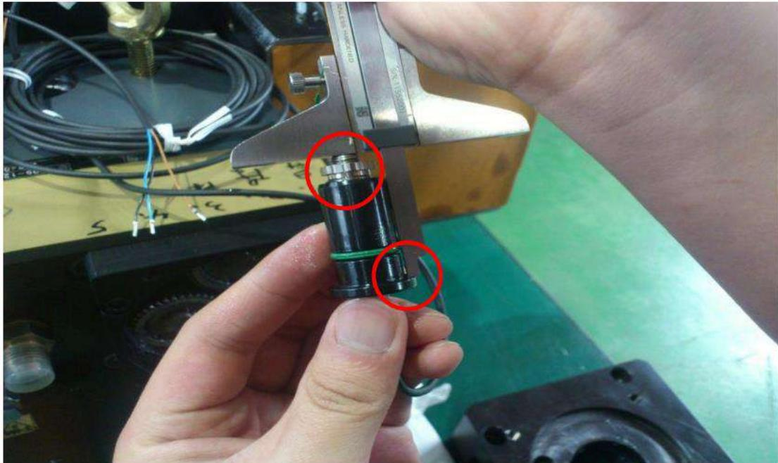
步驟 4. 用開口扳手將固定螺帽拆除後，旋轉 S1 拿出固定座並換上新 S1。
