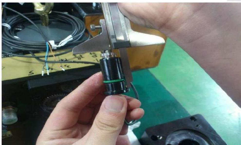
步驟 6. 距離量測完成後，將 S1 放回背板(圖 1),並將固定壓塊鎖緊 (圖 2)。
