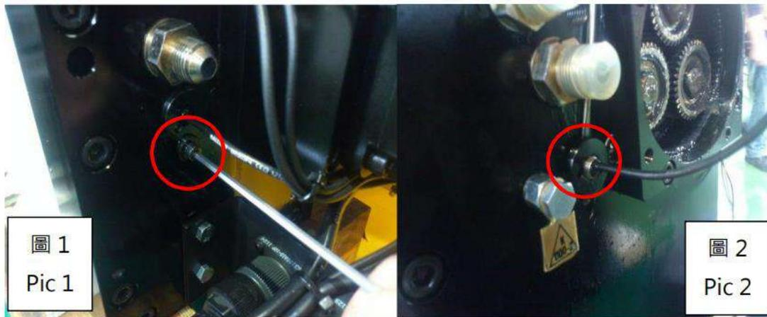
步驟 2. S1 固定座拉出後 · 將近接開關接頭鬆開後把線路移除
