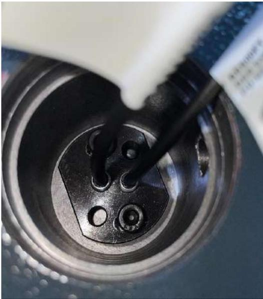
2. Sensor 座取出後，側邊有側固螺絲放鬆後移除舊 sensor
